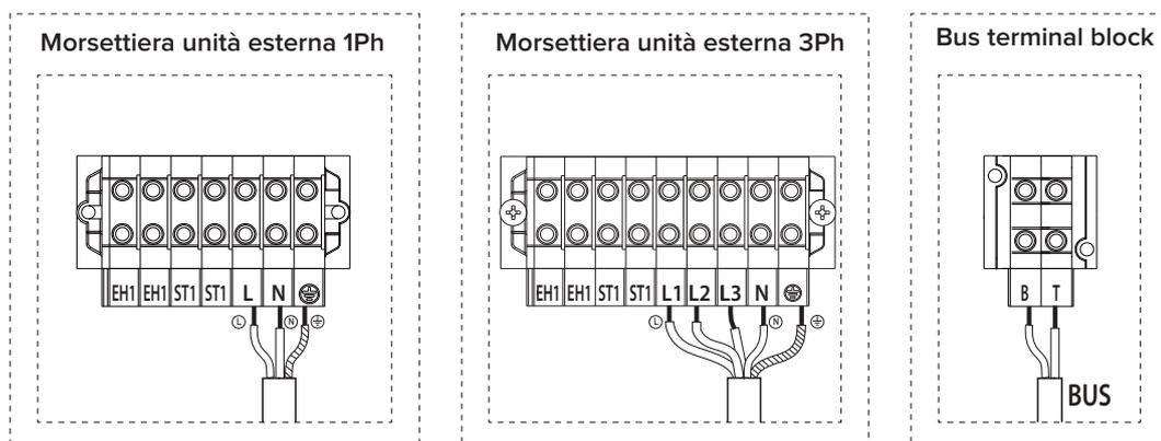
EH1 - Resistenza elettrica per l'antigelo a protezione delle tubazioni idrauliche.
